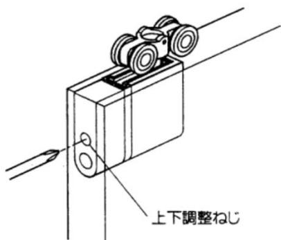
※吊車・カマ錠の上下調整には、電動ドライバーを使用しないでください。調整ビスや内部機構の破損の原因となります。
